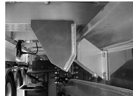
Guide caisse - châssis
